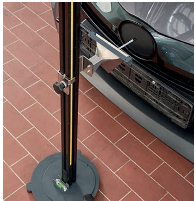
Möjlighet att justera höjdinställningen med mekanisk indikator som pekar på fordonets referenspunkt (emblem)
