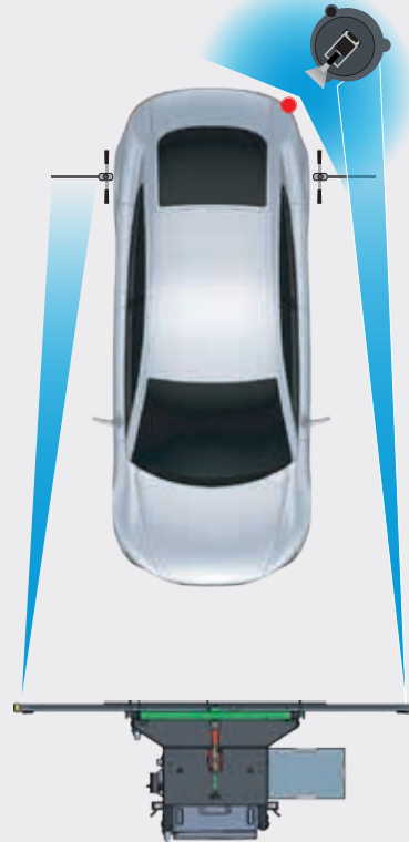
CTA 120-placering för hörnradar med DAS 3000
