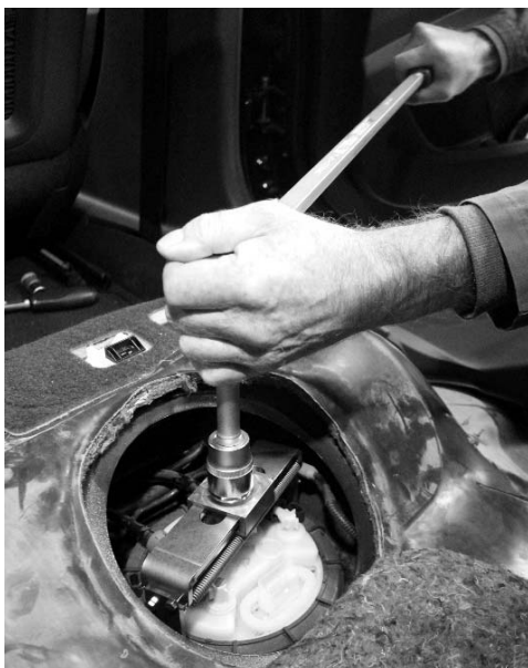
Abb. 4 : Tankgeber-Verschlussring Lösen bzw. Festziehen.
